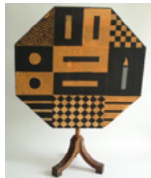
Kleiner Schirm zur Demonstration subjektiver prismatischer Versuche (Hervorbringung von Kantenspektren an schwarzen und weißen Flächen); Tischlerarbeit 1791/92 oder 1805/06
