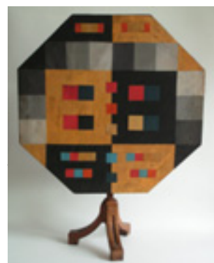
Kleiner Schirm zur Demonstration subjektiver prismatischer Versuche (Hervorbringung von Kantenspektren an farbigen und grauen Flächen); Tischlerarbeit, 1791/92 oder 1805/06
